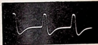
Anode-impulsen bij het afstemmen. De amplitude varieert bij het draaien aan de fijnregeling.
